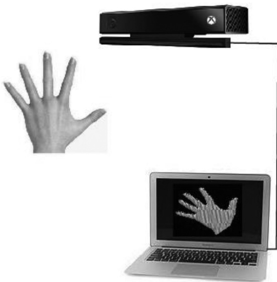
شکل ۱- شماتیک سیستم اندازه‌گیری تصویر عمق از دست
