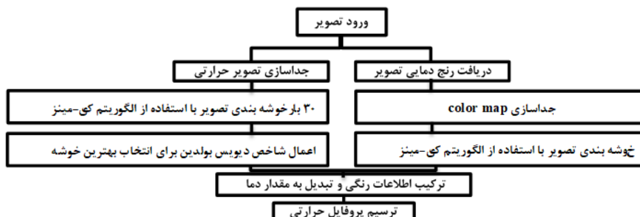
شکل ۱ - فلوچارت کلی پردازش تصویر
