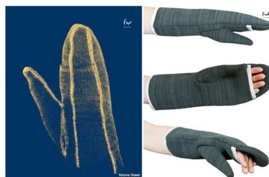
شکل ۶- (الف) تصویری از دستکش تولید شده و (ب) نمای حجمی از دستکش بازسازی شده از آزمایش CT [۱۵].
