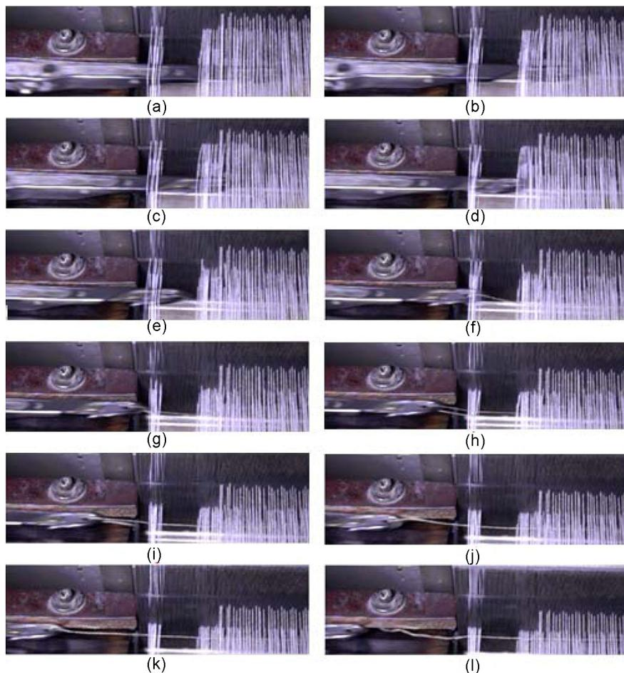
Fig. 2. Weft yarn exit in different times: (a) 0.001 s, (b) 0.002 s, (c) 0.003 s, (d) 0.004 s, (e) 0.005 s, (f) 0.006 s, (g) 0.007 s, (h) 0.008 s, (i) 0.009 s, (j) 0.01 s, (k) 0.011 s, and (l) 0.012 s.
