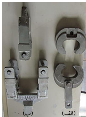
شکل ۲: فکهای کشش (راست) و خمش (چپ).
