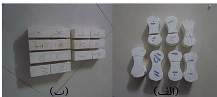
شکل ۴ : نمونه های کششی (الف) و خمشی (ب) پس از انجام آزمون.
