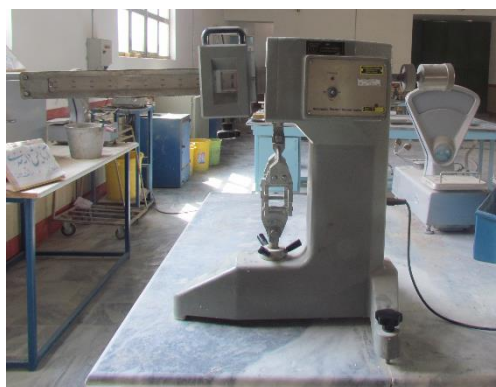
شکل ۳: دستگاه آزمون خمشی و کششی.
