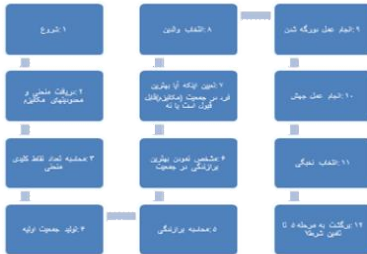
شکل ۳. روند اجرای الگوریتم ژنتیک جهت طراحی مکانیزم چهار میله با منحنی حرکتی مشخص
